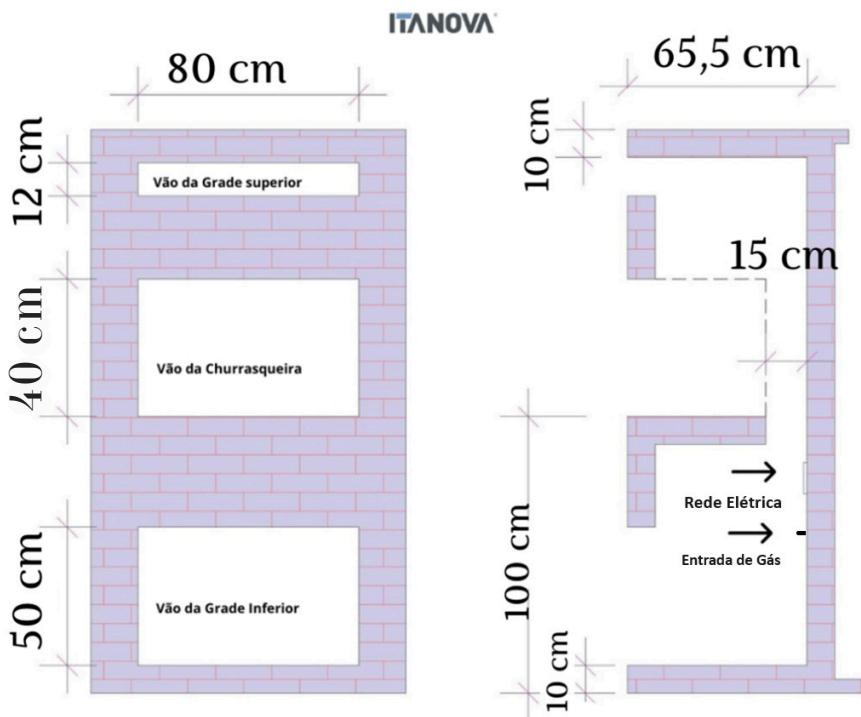
O nicho pode ser construído em alvenaria ou gesso acartonado para alta temperatura e poderá ser revestido com papel de parede, pastilhas, porcelanato, MDF e pinturas em geral.
