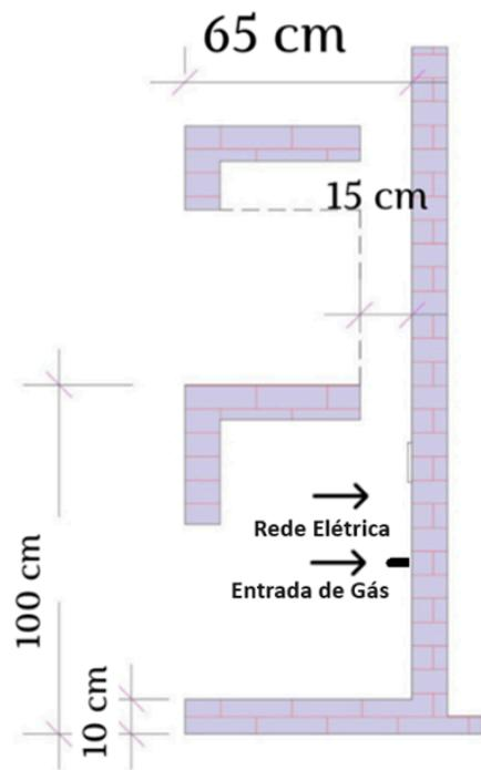
O nicho pode ser construído em alvenaria ou gesso acartonado para alta temperatura e poderá ser revestido com papel de parede, pastilhas, porcelanato, MDF e pinturas em geral.
