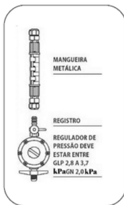
Instalação GLP encanado
