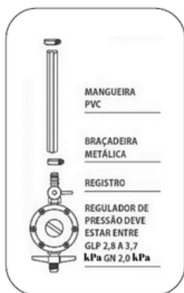
Instalação GLP de botijão P13 ou P45
